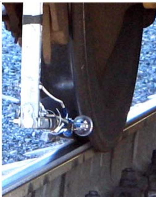
Рисунок 2 - Расположение микрофона шумомера
