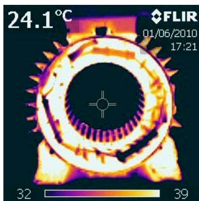
Рисунок 4 – Термограмма статора асинхронного двигателя
