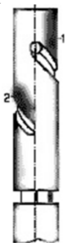
1-зона наибольшего износа, против впускного окна гильзы; 2-зона винтовой кромки
