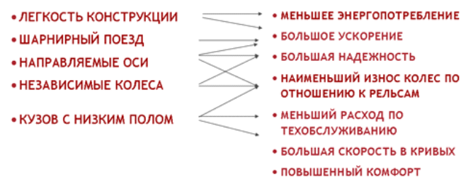
Рисунок 4 - Конструктивные преимущества поездов Talgo
