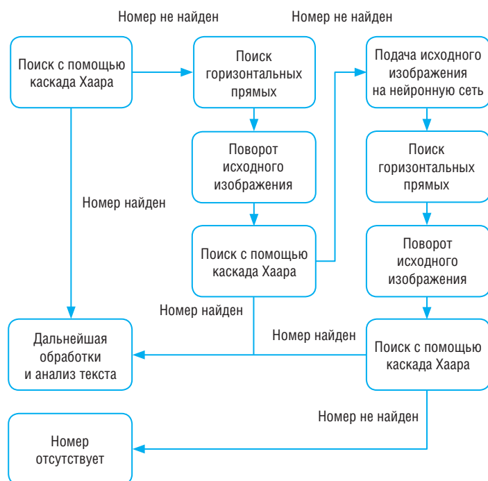
Рис. 4. Блок-схема гибридного алгоритма
