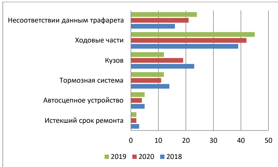
Рисунок 3 – Распределение отказов по основным узлам и деталям:
