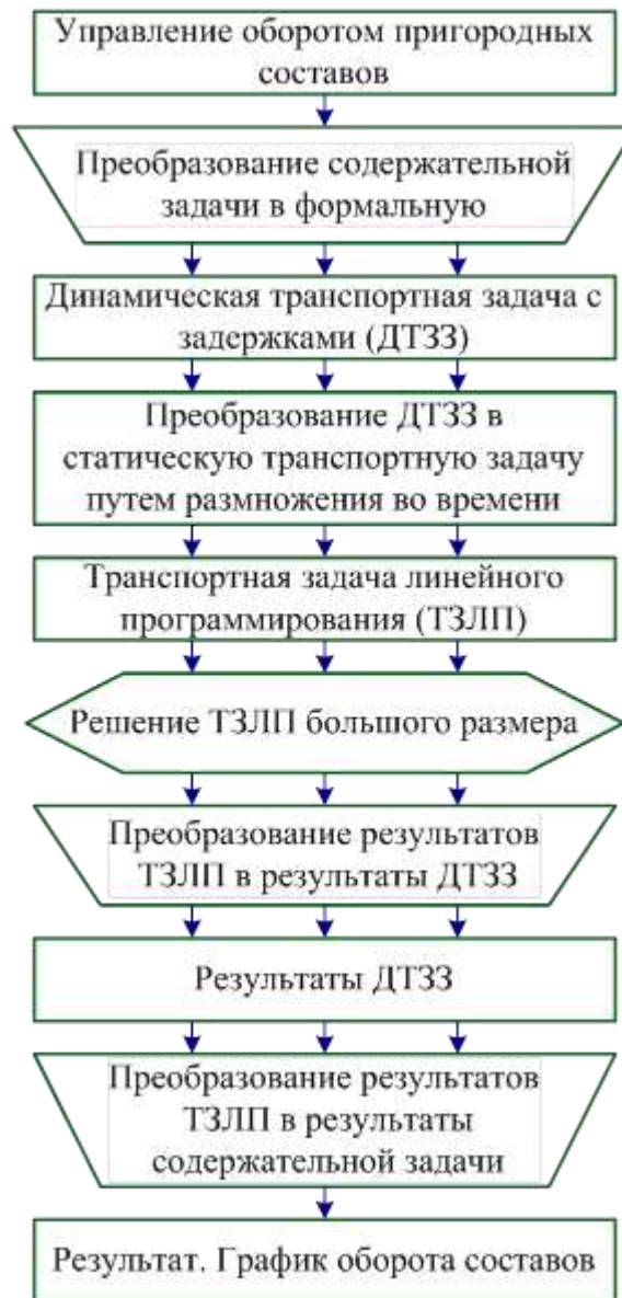
Рисунок 2.3 – Схема автоматизированного решения задачи оптимального управления пригородными составами
