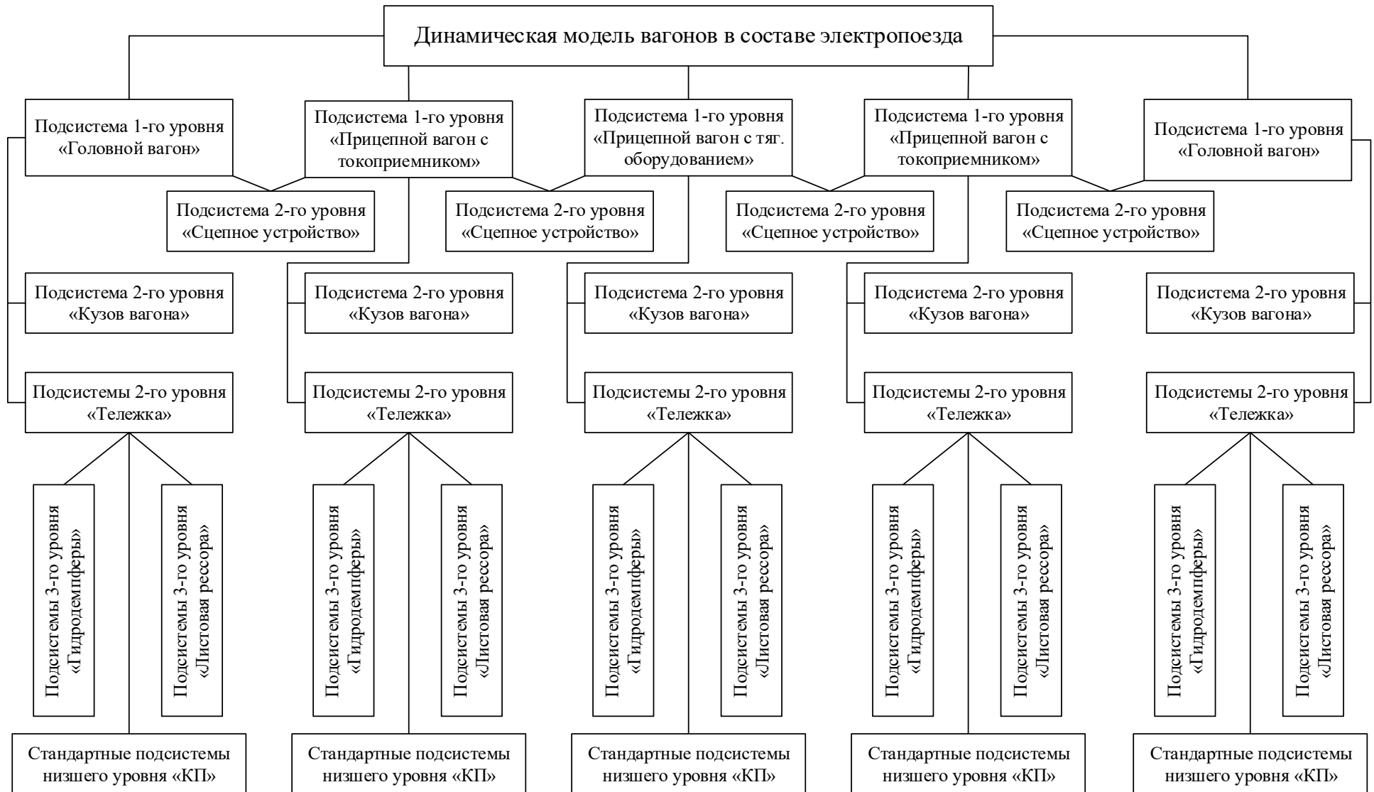
Рисунок 2.3 – Иерархическая структура подсистем динамической модели вагонов в составе электропоезда
