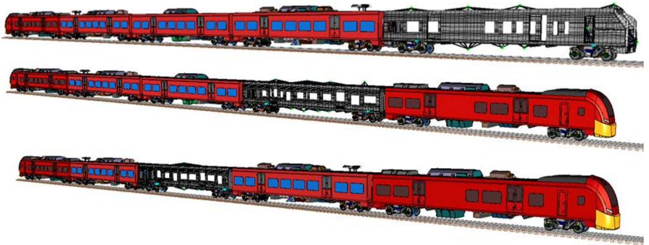
Рисунок 2.22 – Варианты исполнения сцепа электропоезда для исследования динамики
