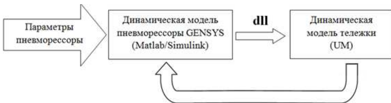
Рисунок 2.14 – Схема интеграции математической модели пневморессоры в программный комплекс UM
